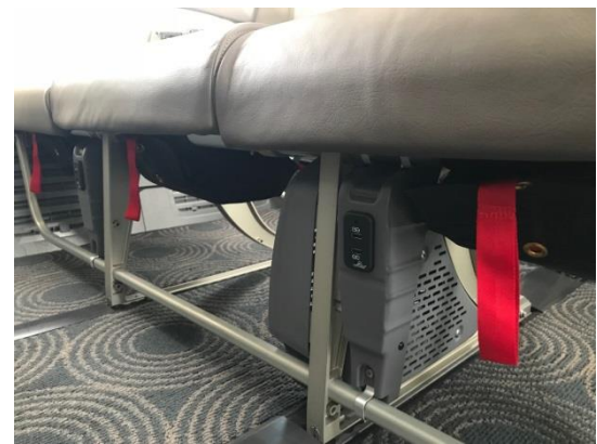
座席下(足元)にUSB電源環境を装備 (3席に対し、4口のプラグを確保)
